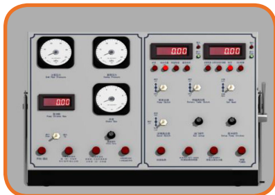
Consola de Perforación y Choke
